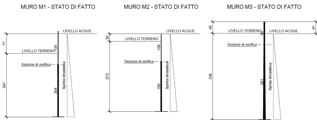
Figura 5: Schema di carico SLU1.
